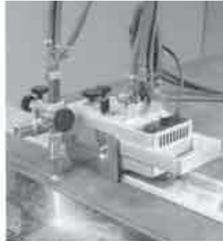
IMP - automata egyenes vágás sínvezetéssel
