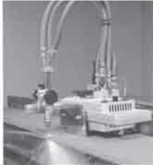
IMP - automata egyenes vágás szögacél vezetéssel
