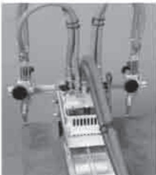
IMP - mindkét oldalán elhelyezett vágófejek párhuzamos vágáshoz
